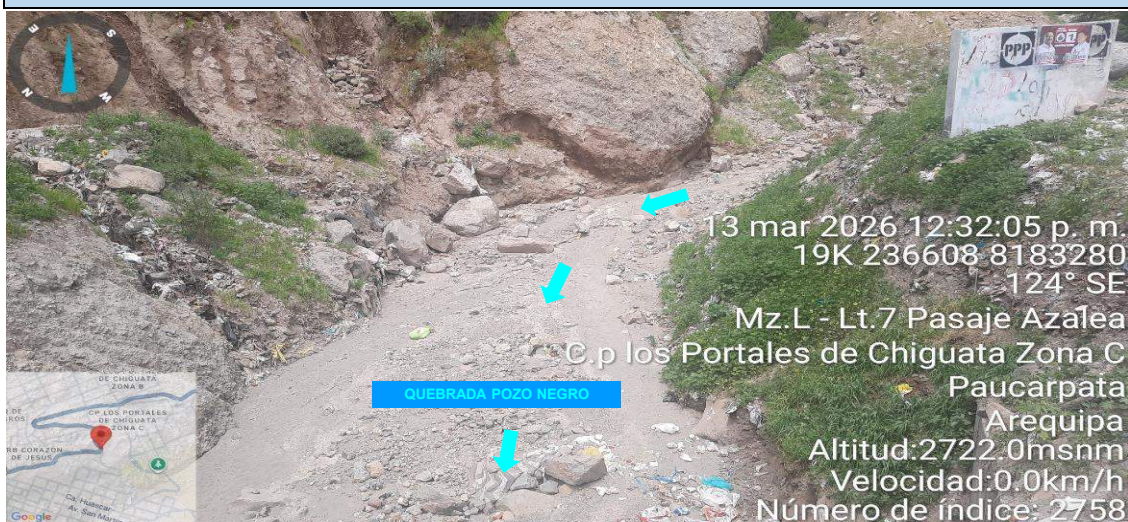
Imagen N° 1. Tramo colmatado en el sector los Portales Chiguata 2, en donde se observa sedimentación en el cauce de la quebrada Pozo Negro.
